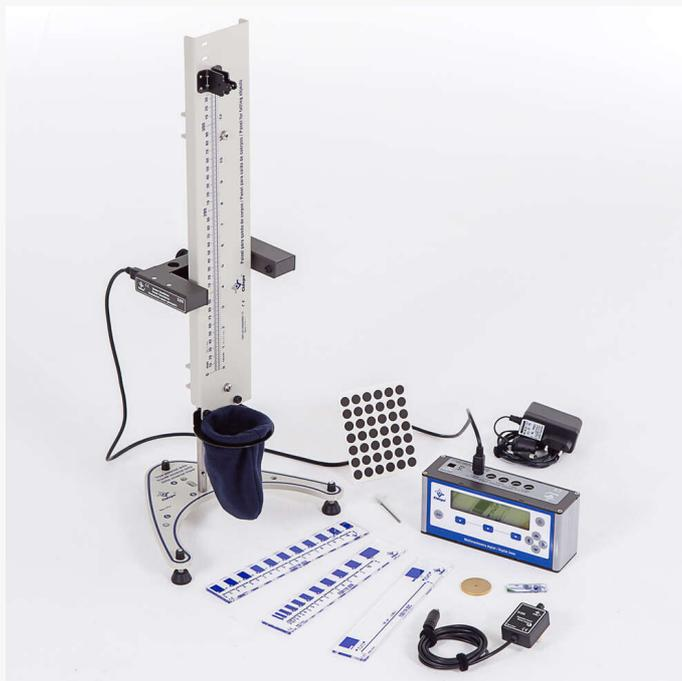
Queda livre, multicronômetro digital com rolagem, 12 funções, tempo de voo, sensor
